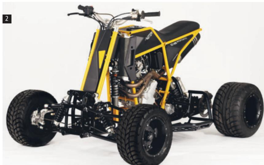
Bergewöhnliche Fahrverhalten möglich: der Neigerahmen, der spezielle Zweiketten-Antrieb samt Getriebe, die äußerst spezielle Lenkung sowie die neu-
